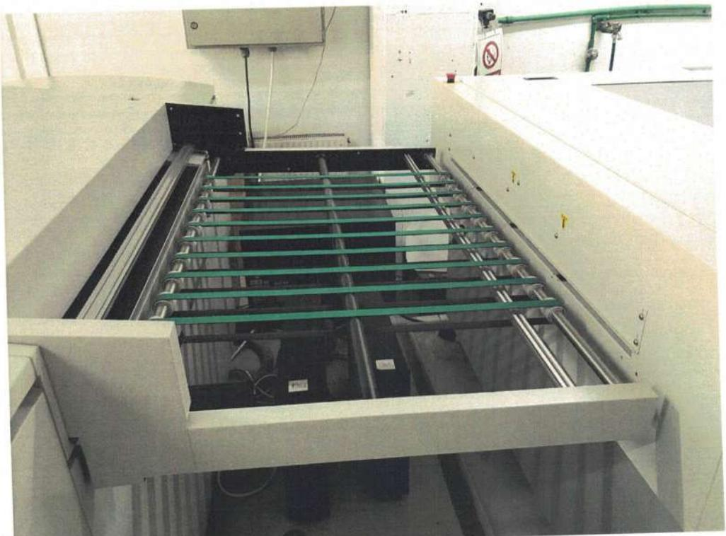
3.54. Mosta za spajanje razvijačice sa CTP-om-1959
